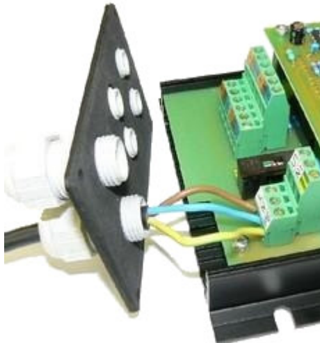
obr. 6 - demontáž části s vývodkami
